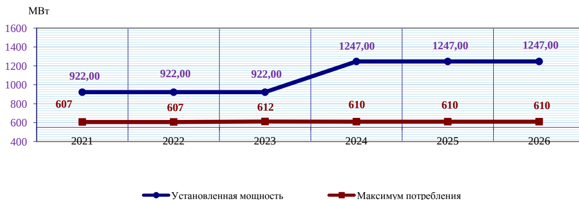
Рис.21. Планируемая динамика располагаемой мощности энергосистемы и величин максимума нагрузки
